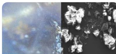
二次侧：冲洗不彻底/沉积颗粒
